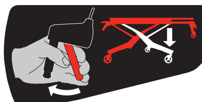
Funzionamento non alimentato Ubicazione: maniglie di rilascio dell'attuatore (2)
