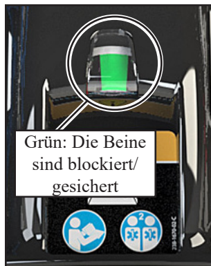
Abbildungen 2 - Statusanzeige der Stützbeine
