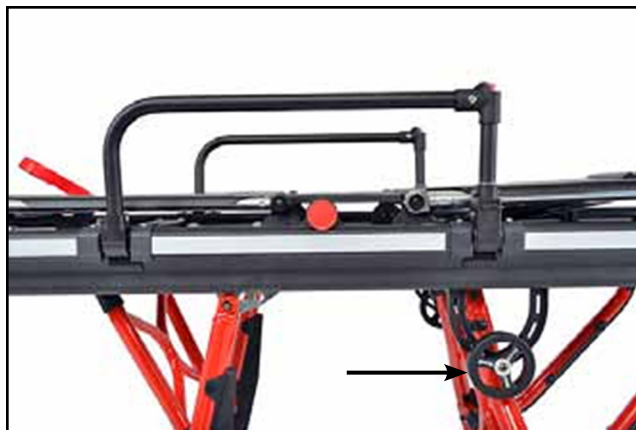
Figura 21- Ruota di caricamento intermedia
