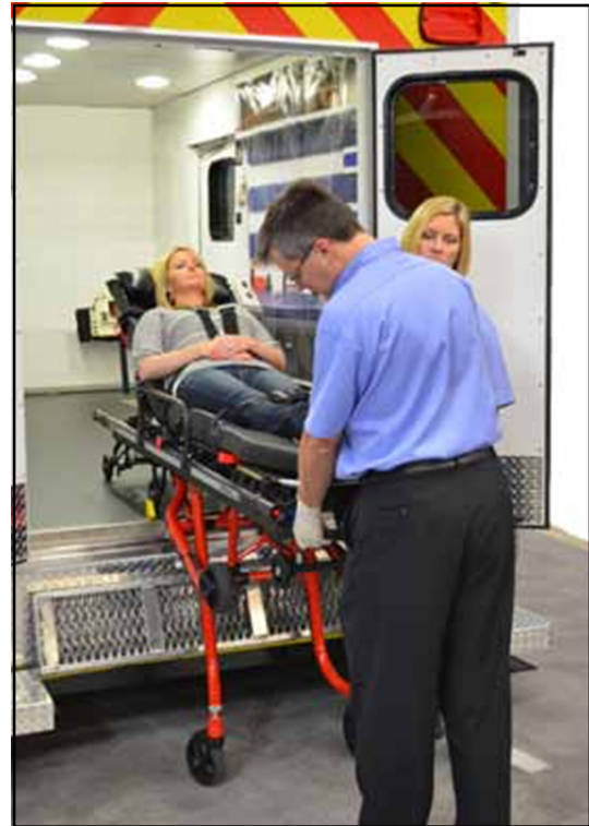
Figura 34 - Verificare che le gambe di controllo si siano bloccate
