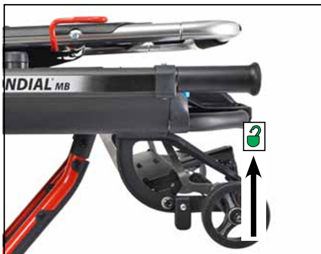
Figura 26 - Pressione sulle ruote di caricamento sblocca le gambe sul lato di caricamento
