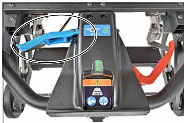
Figura 9 - Leva di rilascio blocco girevole
