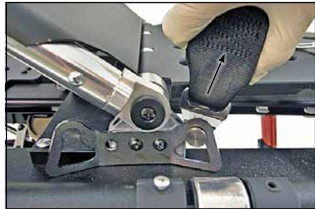
Abb. 4 - Befestigung des Brustriemens
