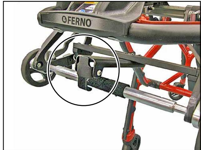
Abb. 27 - Sicherheitsverriegelung
