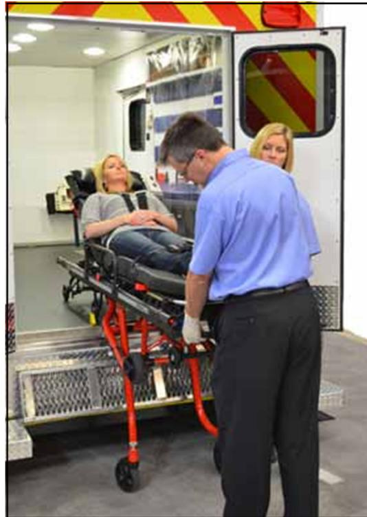
Abb. 34 - Prüfen, ob die Beine auf der Steuerseite arretiert sind
